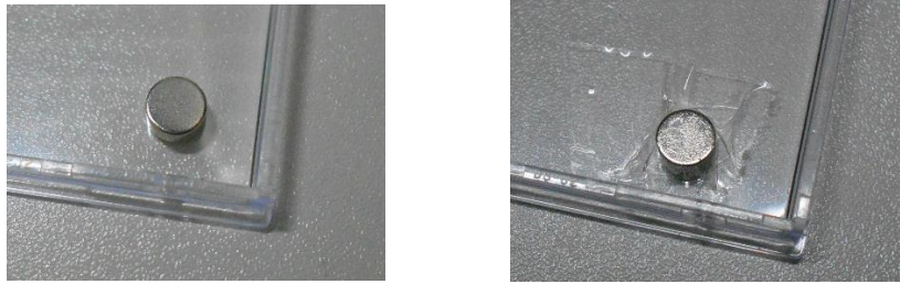
図 39 磁石の取り付け様子(左：固定前・右：固定後)
