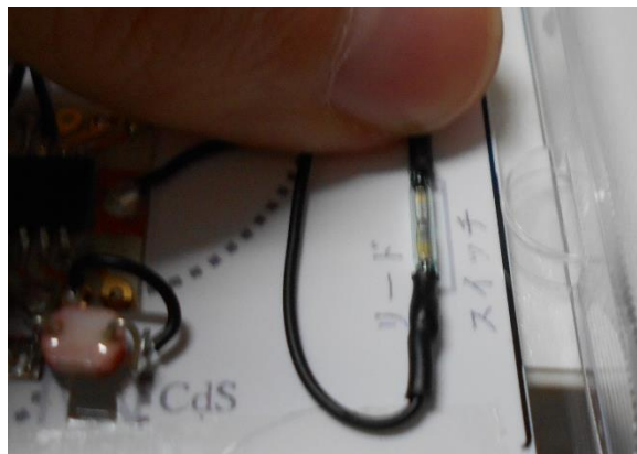
図 31 リードスイッチの取り付けの様子
