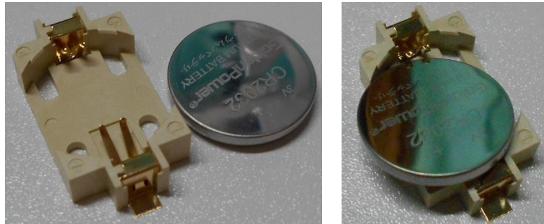
図 27 電池ケースとボタン電池(左)・+を上にしてケースに入れる(右)
